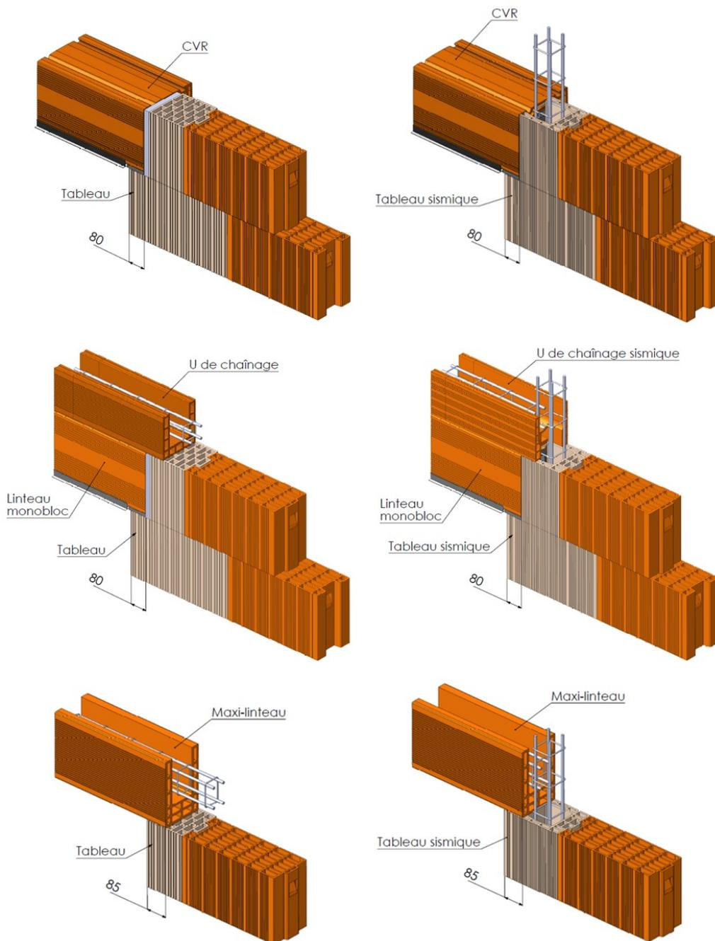
Exemples de mise en œuvre en zone non sismique (gauche) et en zone sismique (droite)
