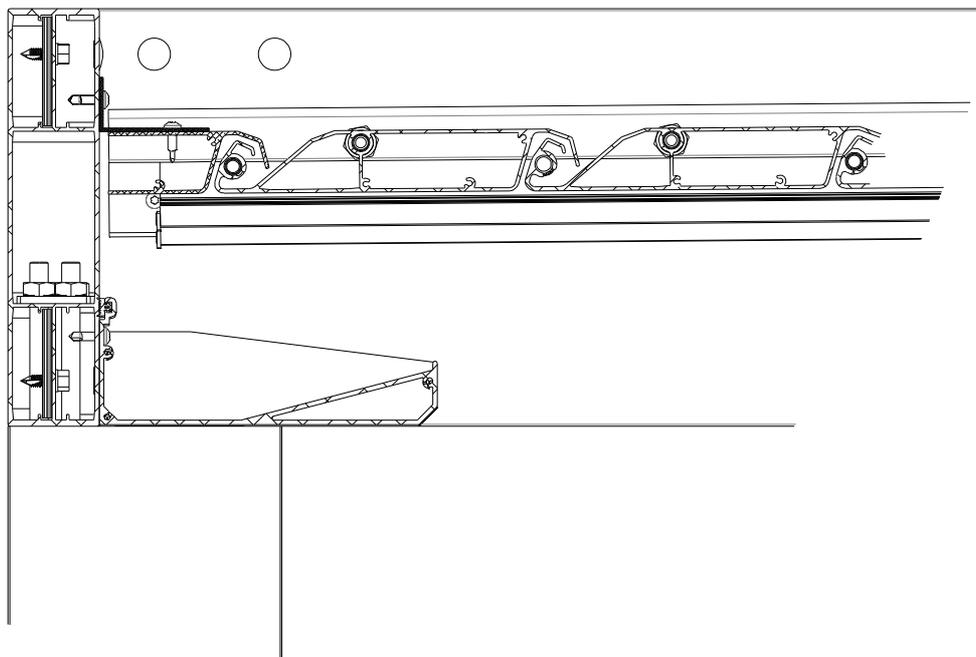
Assemblage lame délimitée avec conservation de l'axe de rotation
