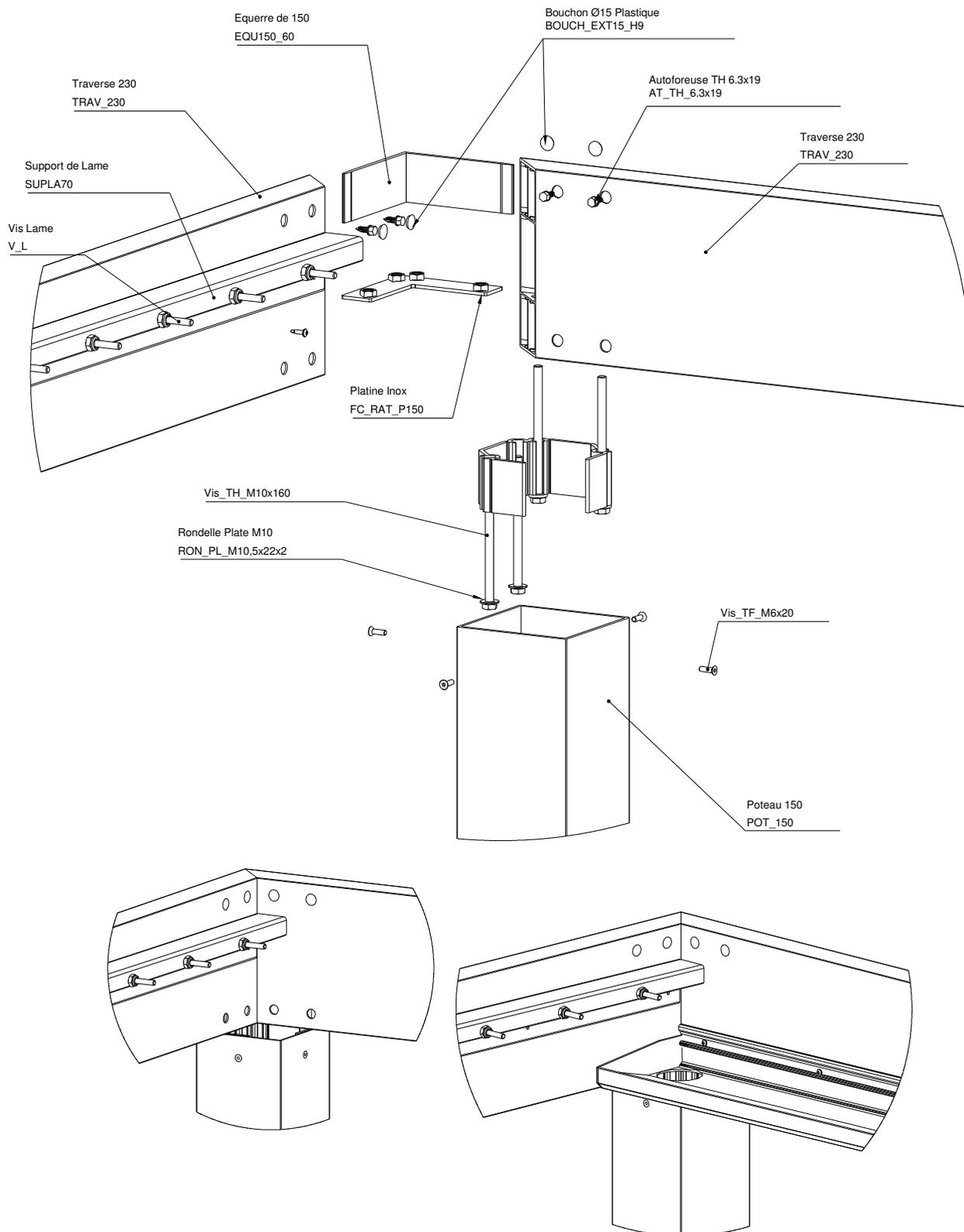
ASSEMBLAGES ANGLES TOITURE (ANGLE SANS POTEAU)
