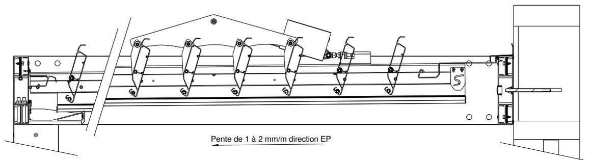
Exemple montage lame blanche (lame de remplissage)
